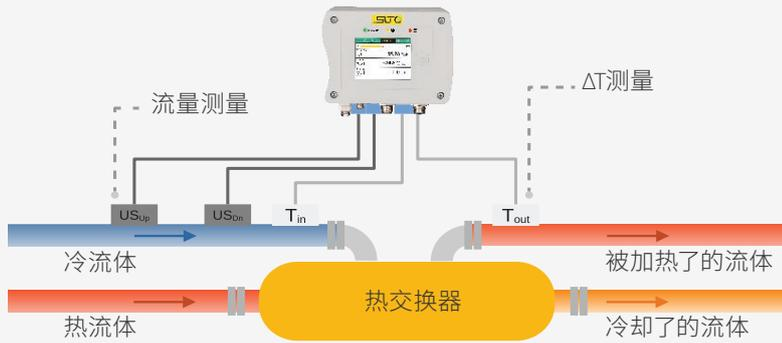
热交换器将热量(能量)从温度较高的介质(热流体)传导到温度较低的介质(被加热的流体)。S461测量冷流体和热流体之间的流量和温差, 根据这些测量结果, 来计算回收的能量。
