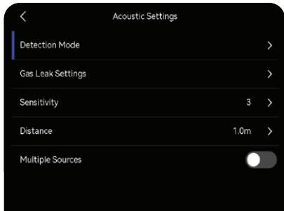
自定义您的专属泄漏检测设置，包括每次损失的成本、货币单位、灵敏度、检测距离和频率范围。
